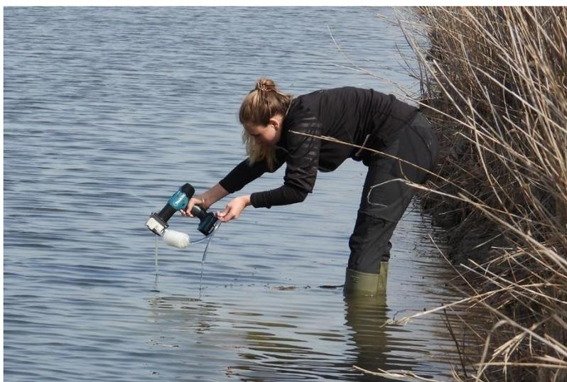
Figure 6: Prélèvement d'eau à l'aide d'une pompe péristaltique de la marque Bürkle
